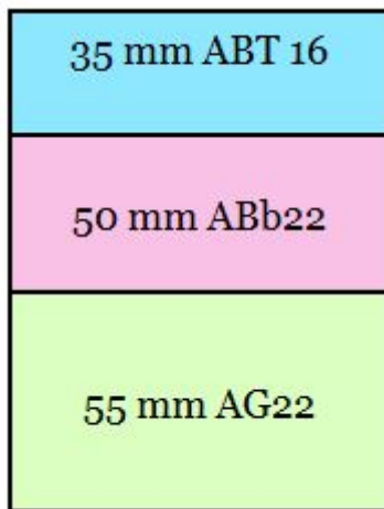
Figur 12 - Referenssträckans väguppbyggnad
