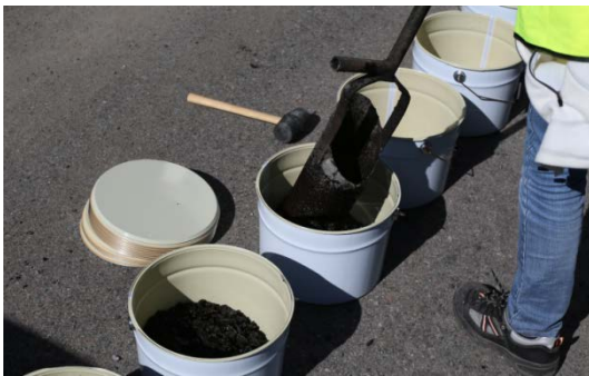
Figur 17 - Uttag prov Base 22
