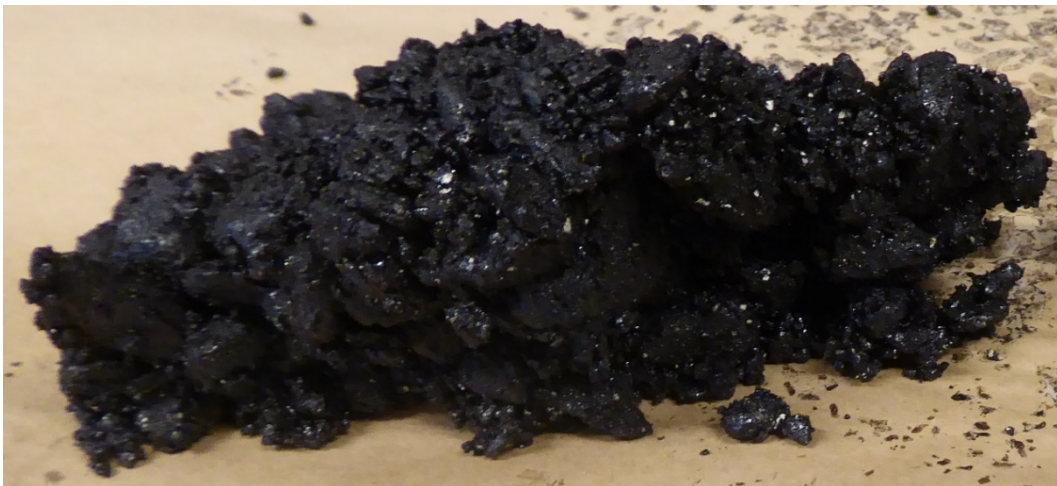
Figur 3 - Täckningsgrad efter "Run off - Wash off"-test
