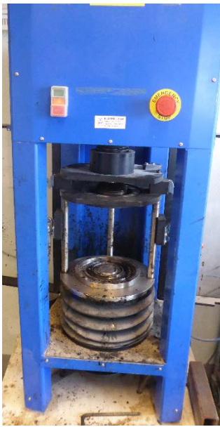
Figur 4 - Utrustningen för att tillverka en provkropp via gyratorisk packning.
