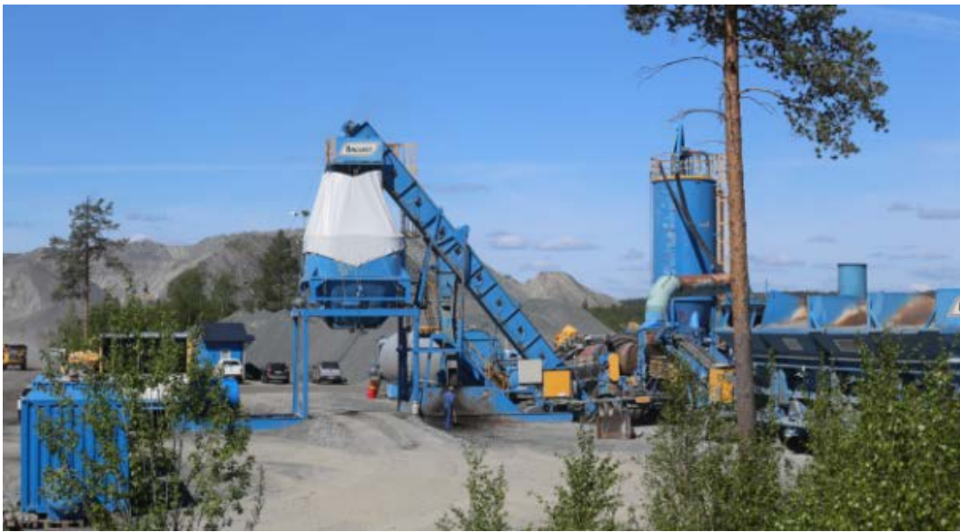
Figur 9 - Varmt mobilt verk, Six-Pack
